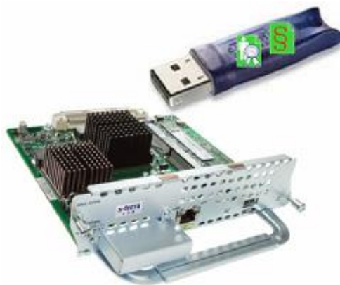
РИС.1. АППАРАТНЫЙ МОДУЛЬ NME-RVPN И USB-КЛЮЧ ETOKEN PRO С СЕРТИФИКАТОМ ПОЛЬЗОВАТЕЛЯ И ПОЛИТИКАМИ БЕЗОПАСНОСТИ
